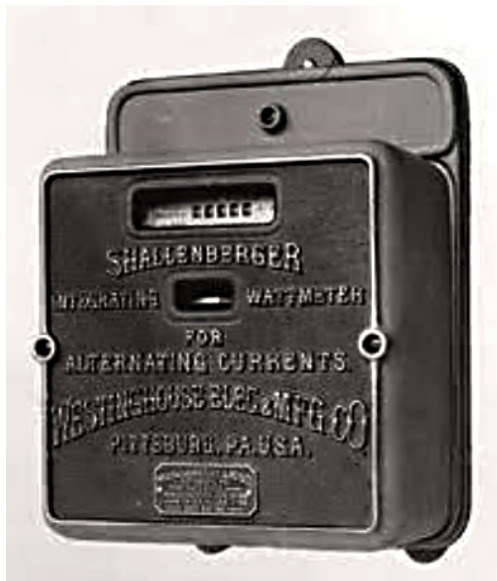
6.2. attēls. Šelenbergera skaitītājs – pirmais komerciāli ražotais indukcijas tipa skaitītājs ar skaitļu rullīšu reģistru.
