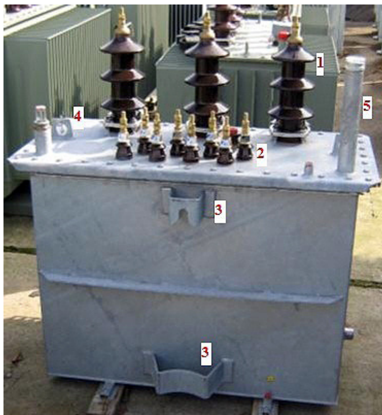
7.5. attēls. 20/1/0,4 kV 160 kVA transformators. Attēlā redzami 20 kV sprieguma izvadi (1), 1 kV un 0,4 kV sprieguma izvadi (2), stiprinājumi transformatora nostiprināšanai balstā (3), transformatora celšanai paredzētās skavas (4)
