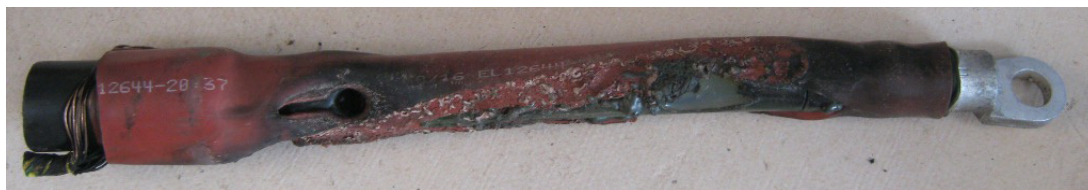
11.10. attēls. Nepareizas kabeļa gala apdares montāžas sekas
